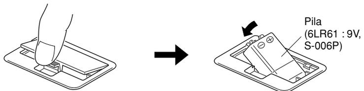
\* Cuando cambie las pilas, ponga atención a las marcas de las polaridades + y - como se muestra en la ilustración de arriba.
